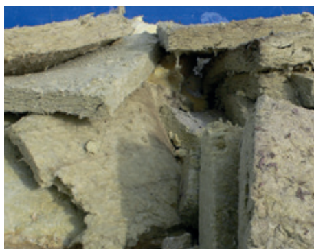
Mineraluld. Mineraluldsaffald skal håndteres som farligt affald, idet mineraluld frigiver sundhedsskadelige fibre.
