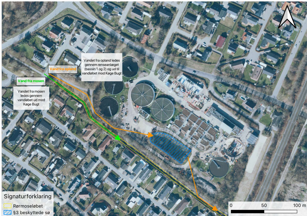
FIGUR 2: OVERSIGT OVER FORHOLDENE EFTER PROJEKTET, HVOR VANDET FRA MOSEN OG REGNVAND ADSKILLES FØR RENSNING.
