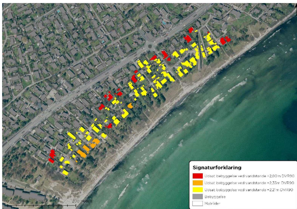
Figur 10: Øverst ses potentielt udsatte bygninger under udvalgte stormflodshændelser ved Olsbækkens udløb med forslag til placering af dige vist med blå i øverste venstre hjørne. Nederst ses potentielt udsatte bygninger under udvalgte stormflodshændelser ved Karlsrunder Strand /2/.
