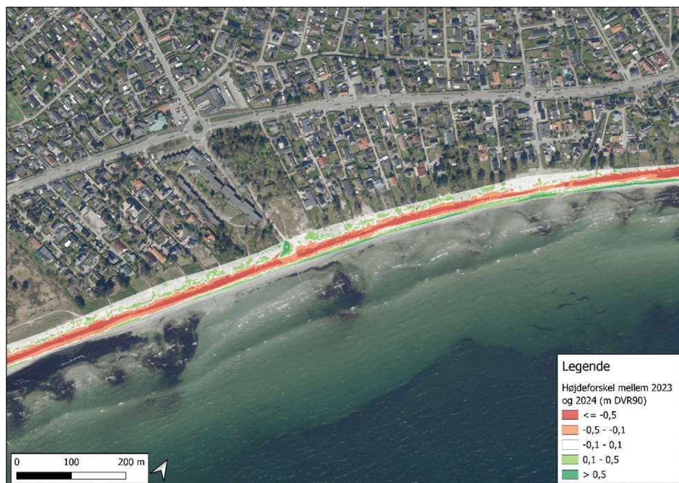
Figur 2-4 Højdeforskel mellem DTM2023 og QuickDHM2024 beregnet ud fra to terrænmodeller. De røde områder indikerer erosion, de grønne indikerer sedimenttilførsel og de hvide indikerer en minimal forskel mellem de to år. Analysen tager ikke højde for vandstanden. Ortofoto 2024.
