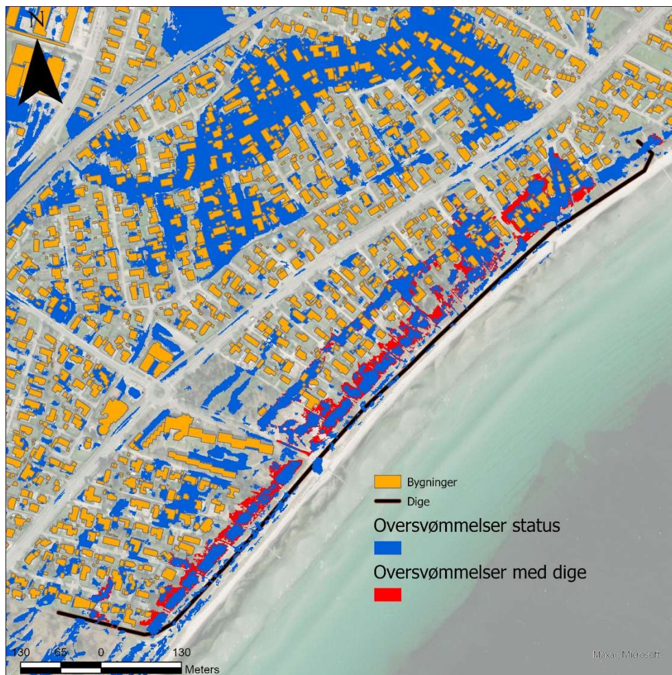
Figur 5-1 Sammenligning af oversvømmelse udbredelse ved status og ved anlæggelse af klitdige/klitrække uden underføringer (Regn dybde = 53 mm)
