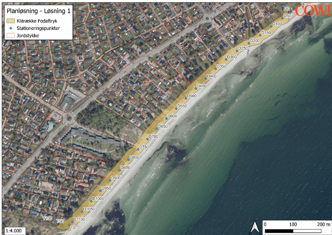
Figur 6-4 Fodaftrek af klitrække og kliddige ved Løsning 1 med stationeringspunkter. Fodaftrek er optegnet ift. Scalgo-Live DTM2019.
