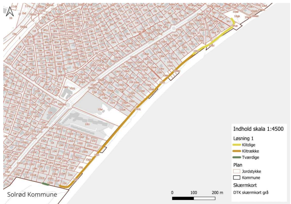
Figur 6-3 Oversigtskort over anlægstyperne ved Løsning 1.
