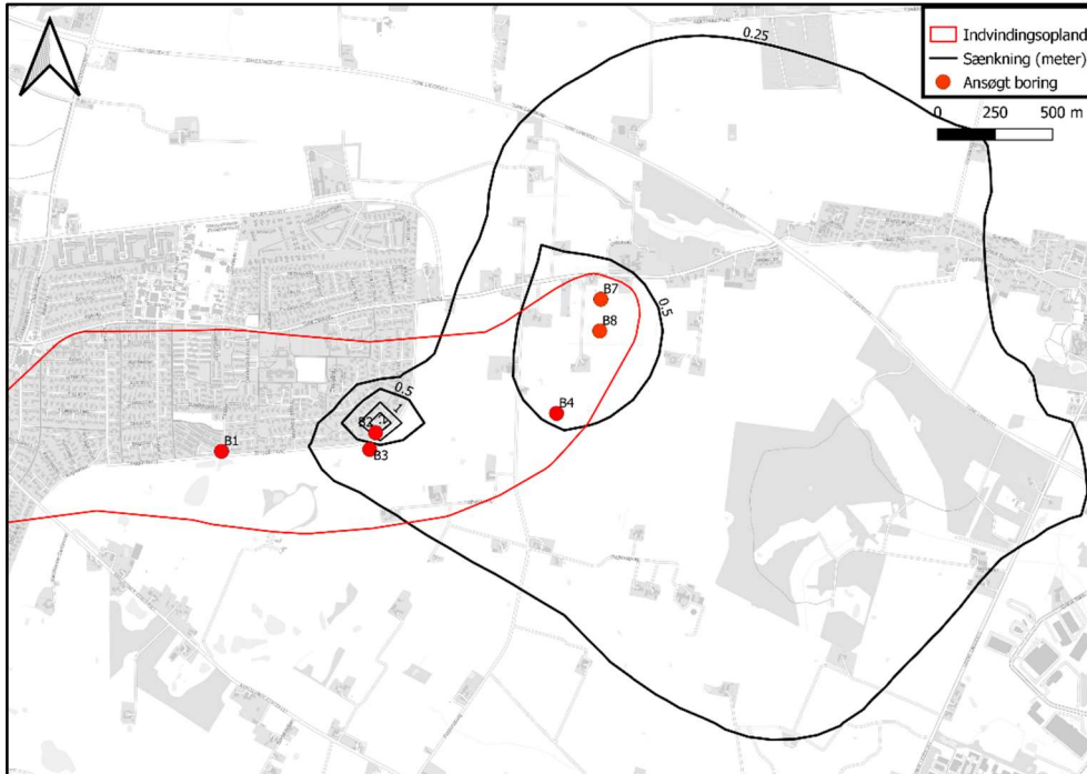
Figur 2: Oversigt over indvindingsoplandet til de nye borerer samt den resulterende sænkning, som der forventes når borererne tages i brug. Sænkningen er vist i meter.
