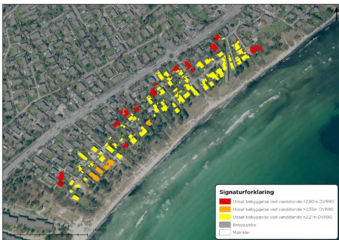
Figur 34: Potentielt udsatte bygninger under udvalgte stormflodshændelser, Karlslunde Strand.
