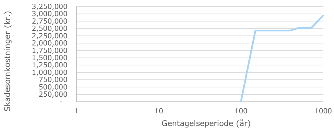
Figur 30: Approksimerede skadeskurve for Olsbæk Strand
