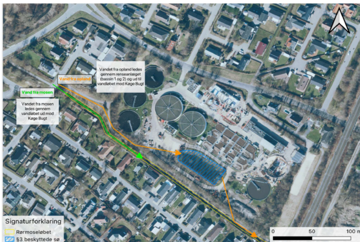
Figur 2. Fra ansøgningsmaterialet. Oversigt over vandforholdene efter projektet, hvor vandet fra mosen og regnvand adskilles før rensning. §3-søen er markeret med blå skravering.
