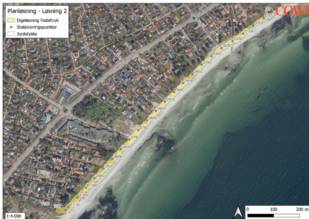
Figur 6-7 Fodastryk af klitdiget ved Løsning 2 med stationeringspunkter. Fodastrykket er optegnet på baggrund af Scalgo-Live DTM2019.
