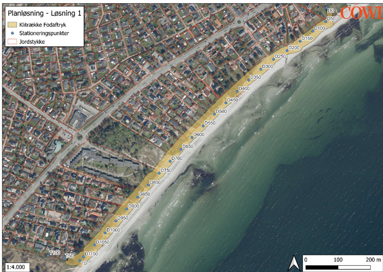
Figur 6-4 Fodaftrek af klitrække og klitdige ved Løsning 1 med stationeringspunkter. Fodaftrek er optegnet ift. Scalgo-Live DTM2019.
