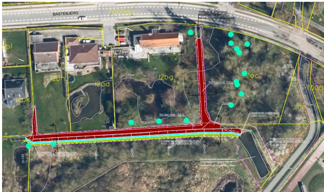
Figur 2-1. Oversigtskort over projektområdet i den nordlige del af Brødmosen. Med rødt er markeret udstrækning af nyt dige. Med turkis og lysgrøn stregsignatur er vist bundbredder og skråningsanlæg for forlægning af Brødmoserenden syd om diget. De grønne prikker er potentielle flagermustræer
