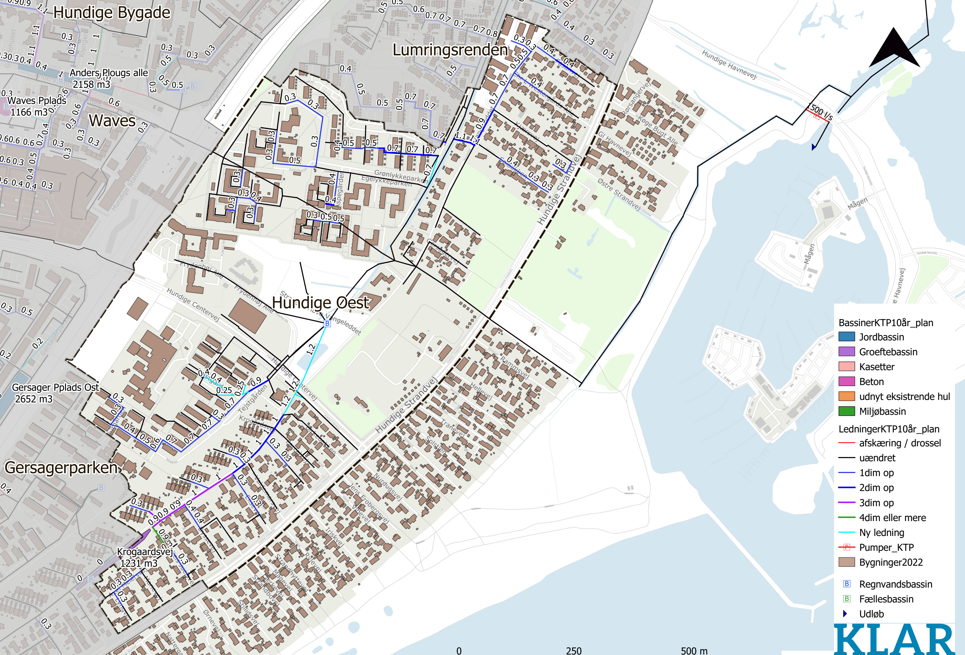
Oplandsplan klimatilpasning T=5 år - ny ledningsdimension angivet i meter
