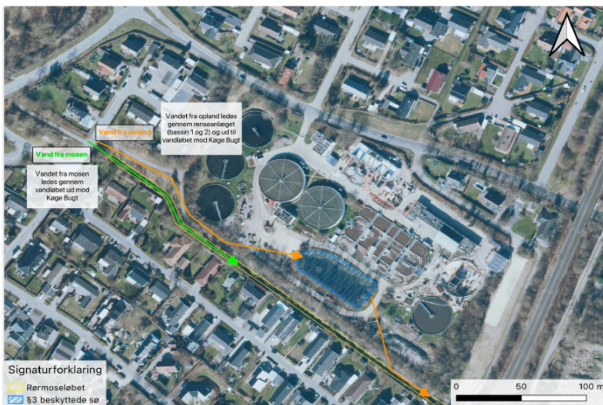
Figur 1. Fra ansøgningsmaterialet. Oversigt over forholdene efter projektet, hvor vandet fra mosen og regnvand adskilles før rensning. §3-søen er markeret med blå skravering.
