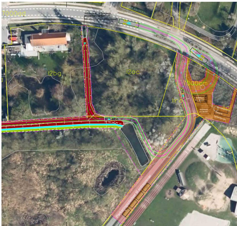
Figur 3.7.1.2. Adgangsvej til skurby/materialeplads fra Bøstebjerg. Kørekurve med 12 m lastbil. Intern kørsel med små entreprenørmaskiner, omlastning ved jorddepoter. For stor størrelse se Tegning N001.
