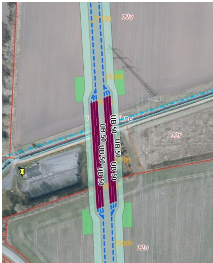
Figur 3: Kort over kabelsystem der krydser Hederenden. Kabeltracé er vist med blå stiplede linje, arbejdsbæltet er vist med lysegrøn og underboringen er vist med mørkebrun/bordeaux. Kortet er hentet fra ansøgningsmaterialet.
