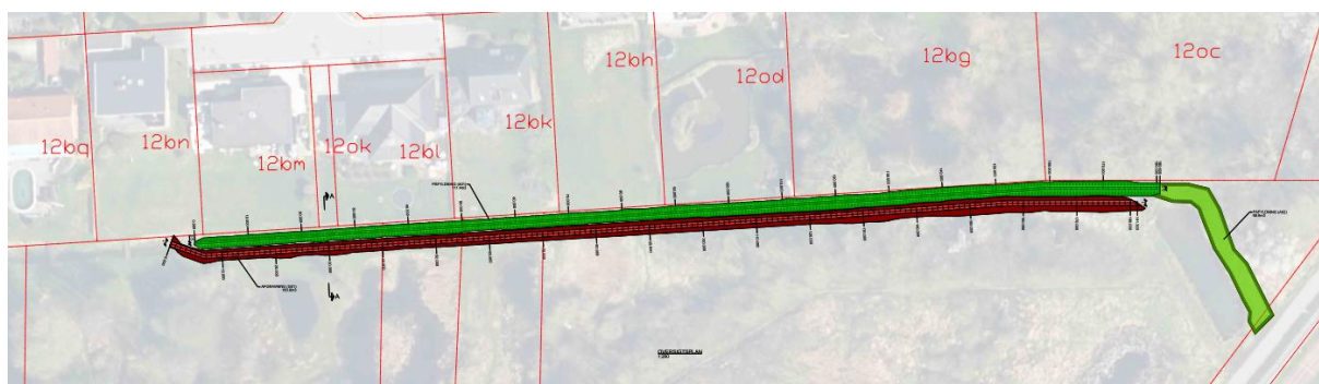
Figur 6.0 – Oversigtstegning. Anlægsprogrammets forlægning af rende (rød) og placering af dige (grøn). Der er sket tilpasninger i nuværende projektforslag. Disse fremgår af kapitel 3.
