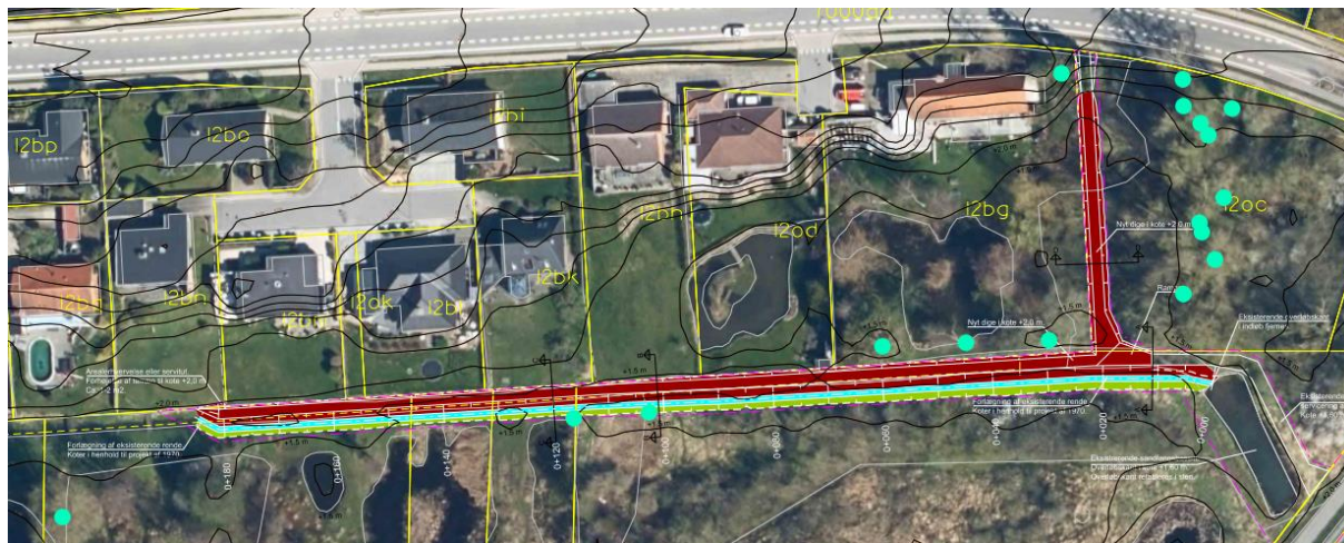
Figur 3.0. Projektforslag. Forlagt rende med dige. Se tegning N0201 for stor størrelse. Der laves dige mod nord op til grundene. Renden flyttes mod syd ud i mosen. Potentielle flagermustrær er vist med grønne cirkler.
